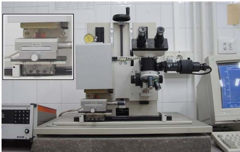
Figura 4. Equipo para ensayos de micro y nanoindentación.
