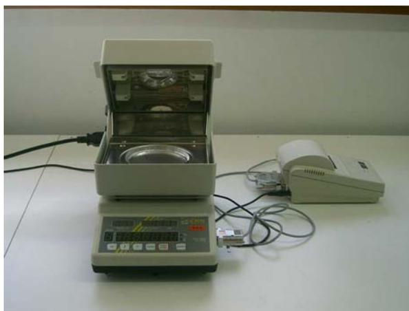
Figura 1. Analizador de humedad
