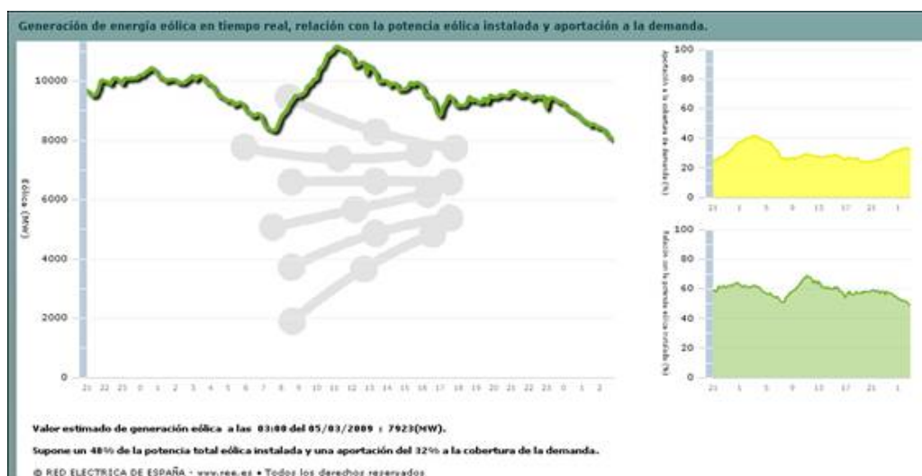
Figura 1: curva de producción eólica del 5 de marzo de 2009. (REE)
