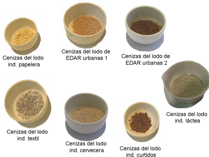
Figura 2: Aspecto de las cenizas de cada muestra de lodos después de su calcinación
