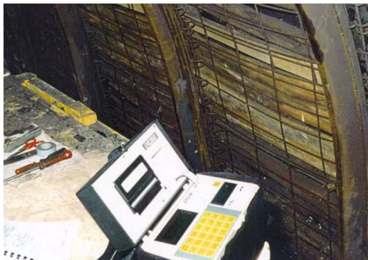
Figura 11. Equipo de medida digital de energía específica de corte
