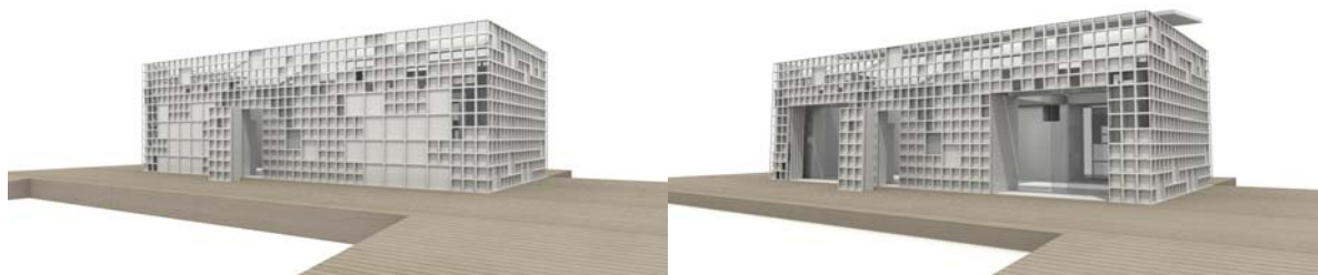
Figura 7. Adaptación de los Invernaderos en Fachada Sur
