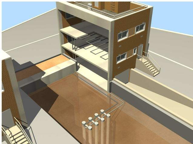
Figura 3. Un ejemplo de interconexión: Intercambiador vertical de geotermia y forjado de inercia
