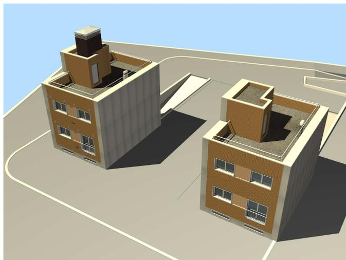
Figura 4. Chimenea de depresión en el demostrador-vivienda experimental
