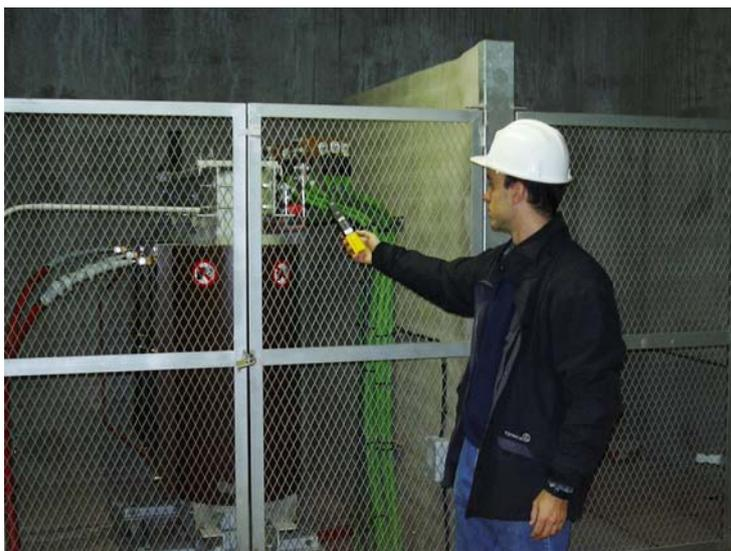
Figura 7. Medición de la exposición a CEM debido a un transformador en la galería de servicios.
