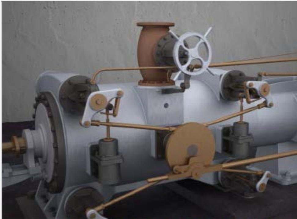
La **Figura 10** muestra una vista del *modelo real* del sistema de distribución de vapor tipo Corliss al cilindro de la máquina.
