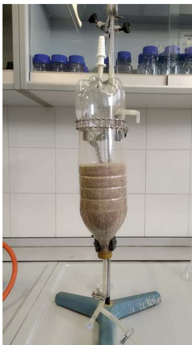
Figura 7: Montaje filtro doméstico
