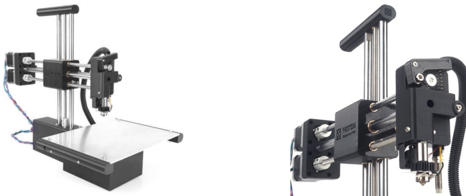
Figura 4: Impresora 3D Proton utilizada como robot cartesiano para el manejo del cabezal de bioimpresión por microextrusión.
