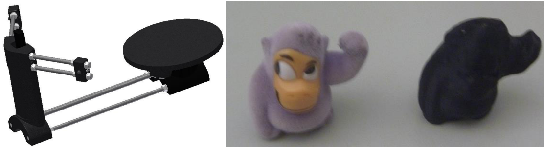
Figura 3: Modelo de escáner utilizado y primeras pruebas de impresión de piezas escaneadas.
