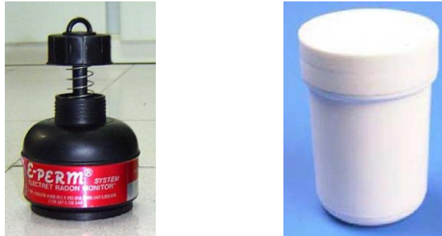
Figura 4. Cámara electret y detector de trazas para la medida de radón. Fuente: SAINZ, C. et al. (2010)
