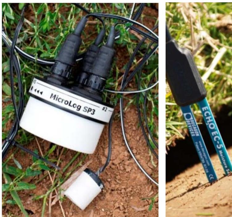
Los sensores registran el grado de humedad del suelo en forma de porcentaje (100% con el sensor en contacto directo con agua // 0% con el sensor al aire sin contacto con la tierra). Un suelo se considera húmedo para los olivos cuando se mide en él un valor por encima del 75%. Un suelo muy seco ofrecerá valores entre un 0 y el 20%. El objetivo deseable son suelos en el entorno del 40 y el 60% de humedad en la época de floración y cuajado del fruto.
