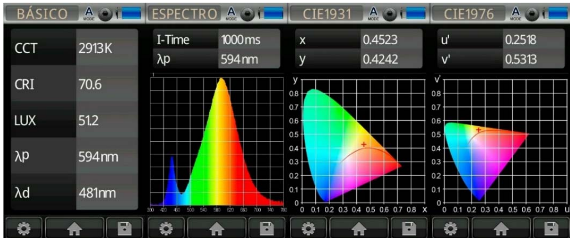
Figura 2: Parámetros medidos por el equipo UPRtek MK350S
