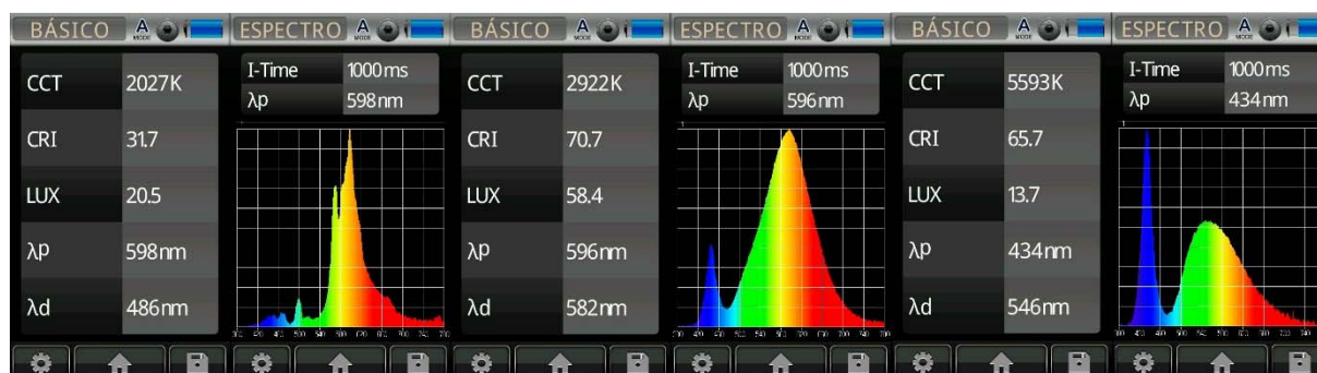
Figura 5: Parámetros medidos por el equipo UPRtek MK350S en Parque Litoral
