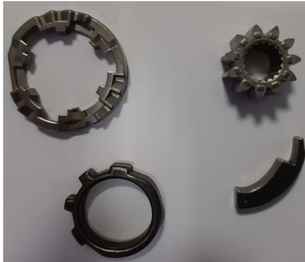
El proceso básico a seguir para el conformado de una pieza mediante sinterizado consta de tres operaciones, como son el mezclado de polvos, la compactación y la sinterización (Perrote y Ferrero, 2013).
