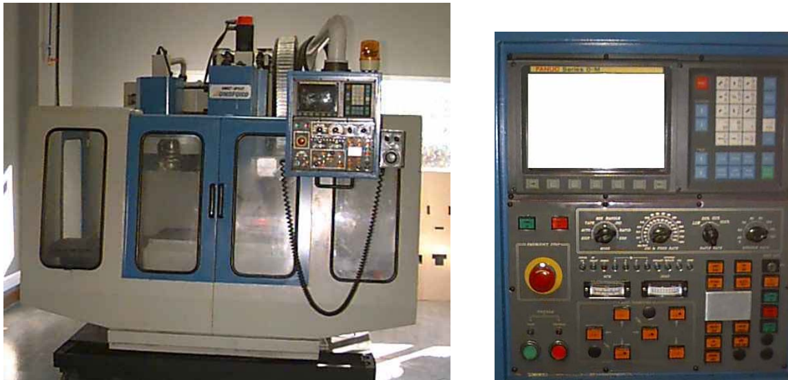
Figura 14: Centro de mecanizado FANUC. Máquina-herramienta y panel control (CNC)
