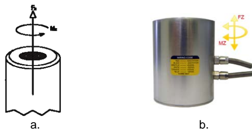
Figura 5: a. Diagrama de Forças e Momentos; b. Célula Multi-componente Seleccionada (Futek, 2009)
