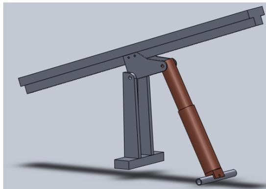
Para um funcionamento do sistema de elevação do *standing frame* são necessários vários componentes e acessórios hidráulicos, desde o actuador hidráulico, o controlador, válvulas, ligações flexíveis, entre outros acessórios. A Figura 4 apresenta os principais componentes.
