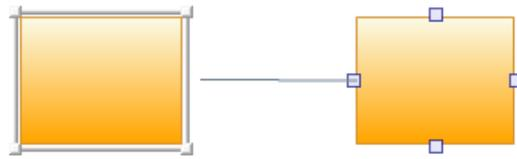
En la Figura 2 se muestran los puntos de anclaje donde los flujos pueden llegar al proceso: los flujos se asocian a los puntos de anclaje, y será dentro de las propiedades de cada flujo individual donde se establezcan las entradas y salidas que se están comunicando. Los flujos en sí mismos no requieren configuración, si no que son fruto de las operaciones realizadas con ellos.
