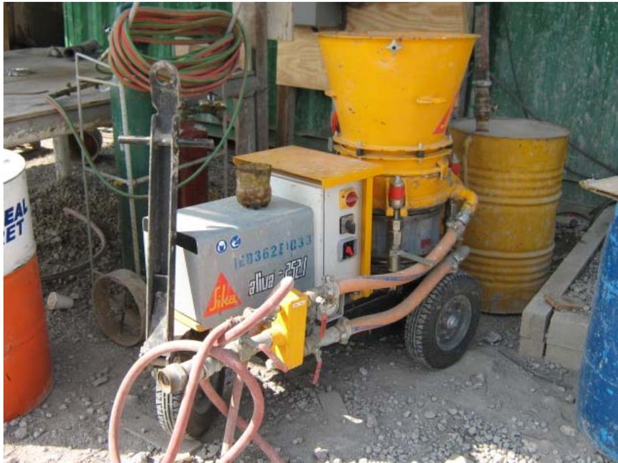
Fig. 3 Equipo utilizado para lanzar concreto (mezcla seca), fuente: propia
