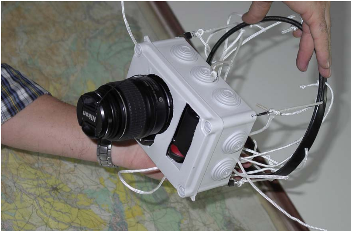
Figura 5: Aspecto de la cámara en la caja con el armazón.
