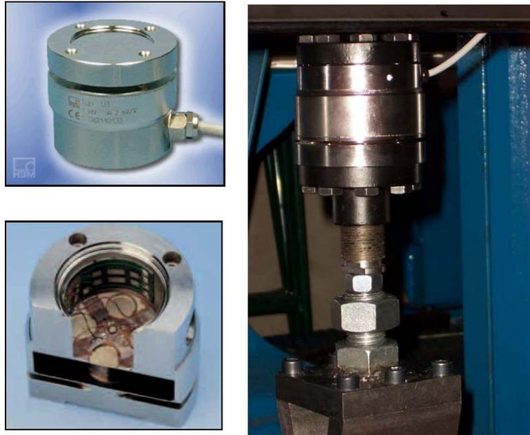
Figura 8. Detalle de la célula de carga.
