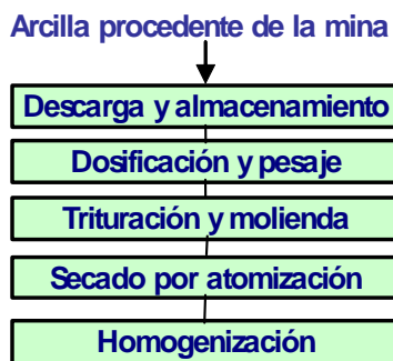
Figura 3. Proceso de molturación y atomizado.
