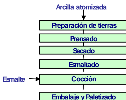
Figura 5. Esquema del proceso de producción de la baldosa cerámica (pavimento y revestimiento).
