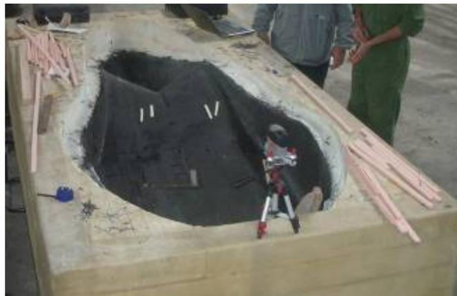
Figura 6. Molde inferior laminado.
