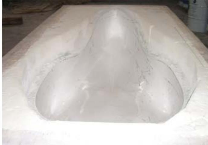
Figura 5. Molde mecanizado y preparado para la laminación de la parte superior de la carrocería.
