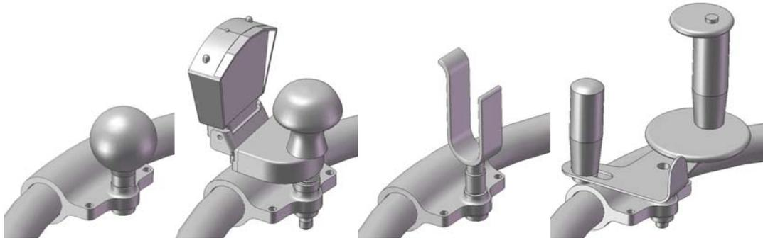
Figura 2. Modelización de adaptaciones de conducción de dirección. Pomo, pomo con telecomando, horquilla y empuñadura de dos puntos.
