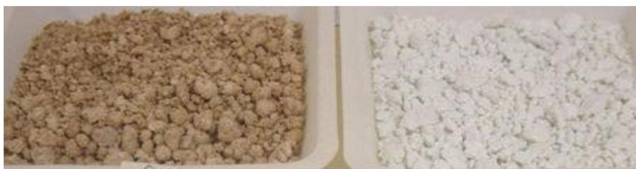
Figura 6. Mezclas de FLAVOLIVA y DIAPIM acondicionadas. Tamaño de grano > 2.5 mm -> rechazo
