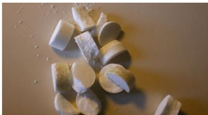
Figura 5. Fractura del comprimido por baja compacidad
