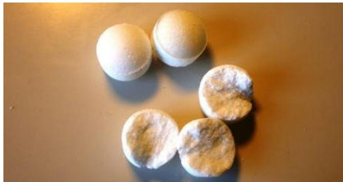
Figura 4. Fractura por adherencia a punzón del casquete superior
