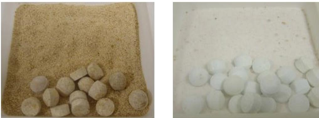
Figura 8. Comprimidos de FLAVOLIVA y DIAPIM. Deshumectación forzada. grano <0.63mm
