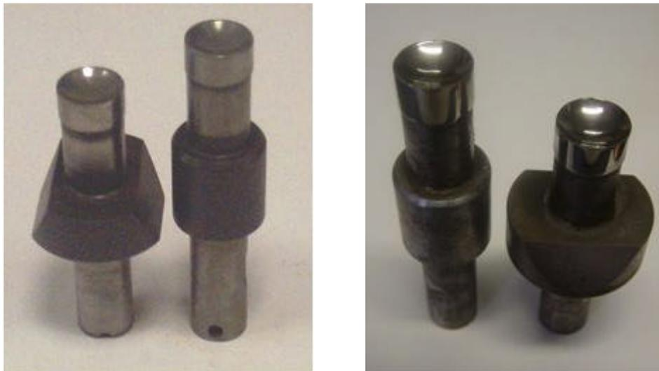
Figura 10. Punzón inf. y sup. recubiertos de carburo de cromo (izqda.) y tungsteno (drcha.)
