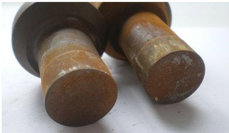
Figura 2. Corrosión / oxidación de los punzones
