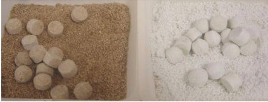
Figura 7. Mezclas pretratadas y comprimidos obtenidos. Tamaño de grano < 2.5 mm
