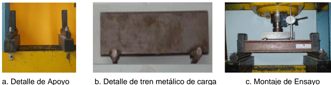
Figura 6. Ensayo sobre vigas I para obtención de Módulo de Elasticidad y Módulo de Rotura.
