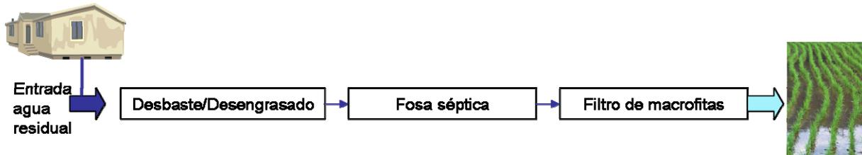
Figura 2. Esquema de la secuencia de tratamiento de depuración seleccionada para 100 habitantes equivalentes
