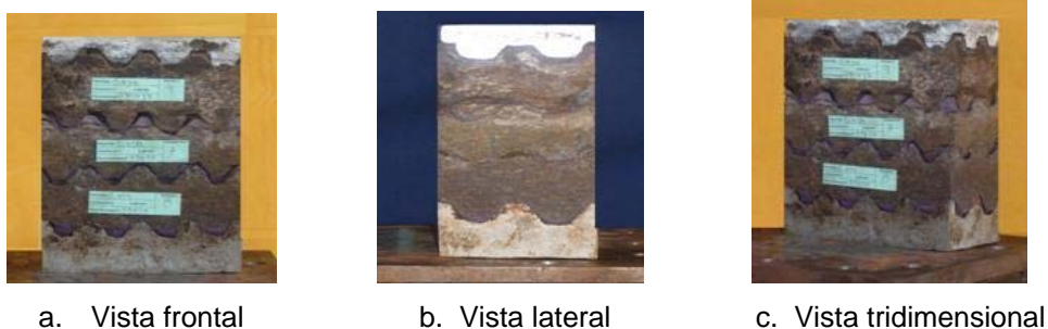
Figura 7. Murete típico para ensayo compresión.
