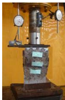
a. Falla típica presentada por murete
