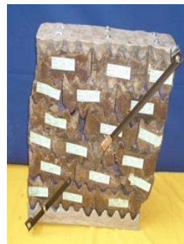
Figura 14. Murete después de falla
