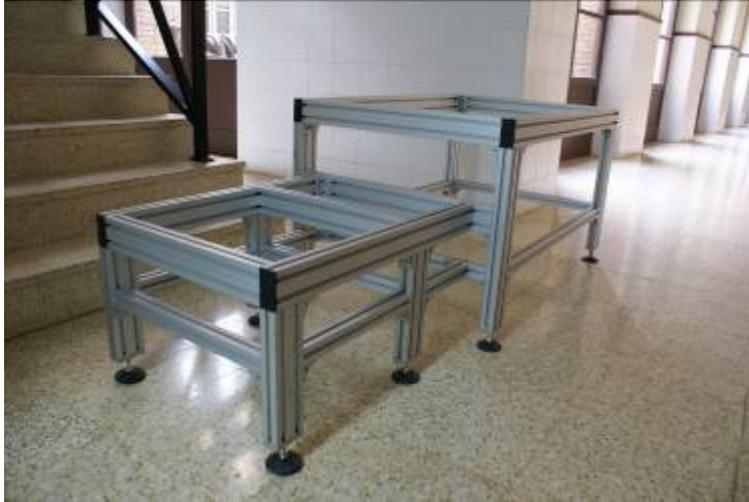
Figura 3. Estructura de aluminio del banco de potencia.
