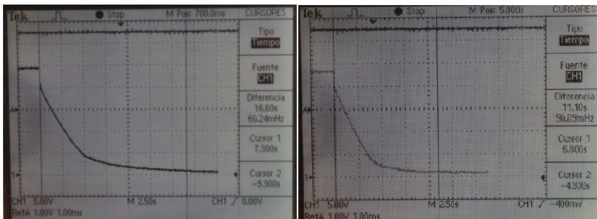
Figura 5. Curvas de descarga del driver ELG-150-24A (izquierda) y ELG-75-24A (derecha) del fabricante Meanwell funcionando a su potencia nominal.
