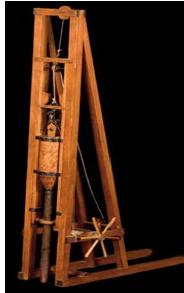
Figura 2: A) Códice Atlántico, f 785, Biblioteca Ambrosiana de Milán. B) Maqueta de máquina para pilotes de Leonardo, del Museo Nacional de Ciencia y Tecnología de Milán (Imagen de la Web de ese Museo). C) Máquina actual de pilotaje, en una obra de un puente.
