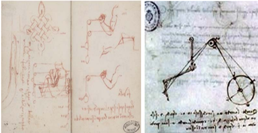
Figura 3. A) Estudio de mecanismos para ala mecánica para planeador, realizado entre 1505-1506. Códice Atlántico (C.A.) 934r B) Estudio de Ala móvil (1495), C.A. 844r
