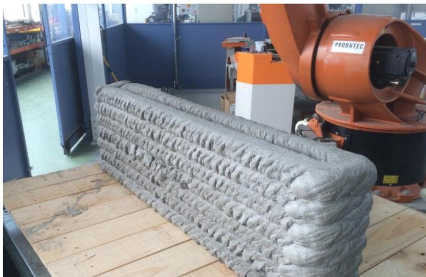
Durante el proceso de impresión de las estructuras, se tuvieron que realizar paradas en la deposición del material para el fraguado del previamente ya impreso que garantizara la correcta sustentación de las siguientes capas una vez impresas.
