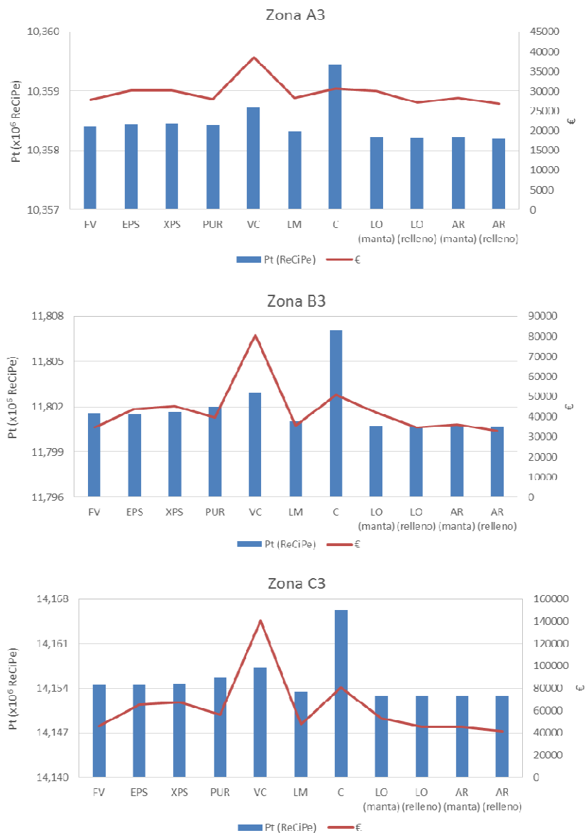
Figura 4. Impacto ambiental (ReCiPe, Pt) y Coste (€) por zona climática, para cada material de aislamiento térmico
