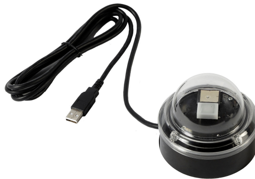
Figura 3: Fotografía de la sonda con sensores GPS y luxométrico.
