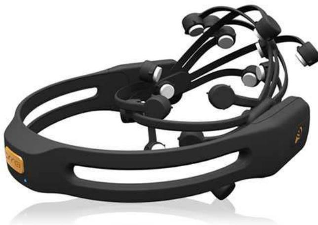
Como característica fundamental, Emotiv Eloc, presenta un tamaño inferior a los dispositivos tradicionales de ICC, resultando absolutamente portable dado que su alimentación se realiza mediante baterías con una autonomía de 12 horas, y la transferencia de datos se realiza mediante conexión wireless. Por otra parte, el dispositivo dispone de un sistema giroscópico que permite conocer con precisión la posición de la cabeza del usuario.
