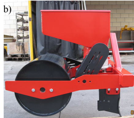
Figura 5. Detalles de la máquina. a) Conjunto de máquina, b) Depósito, cilindro, reja, transmisión al dosificador, c) Máquina trabajando
