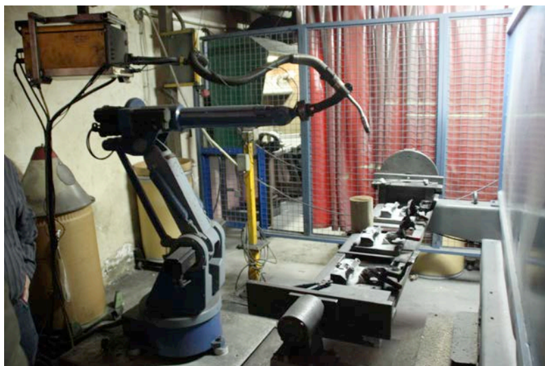
Figura 1: Sistema robot de soldadura GMAW de planta de fabricación
