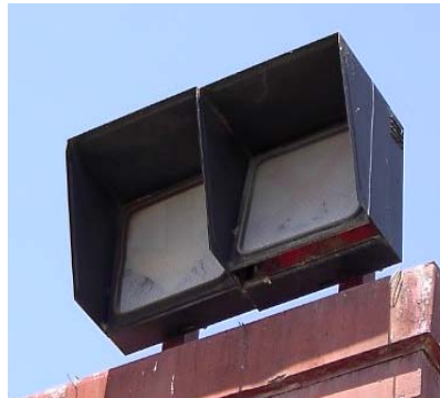
Figura 5. Señalización con protección lateral contra la luz solar
