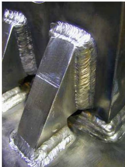
**Figura 1: Producto soldado mediante soldadura MAG. Cortesía de Cortesía de Mecanizados de Precisión de Navarra**
