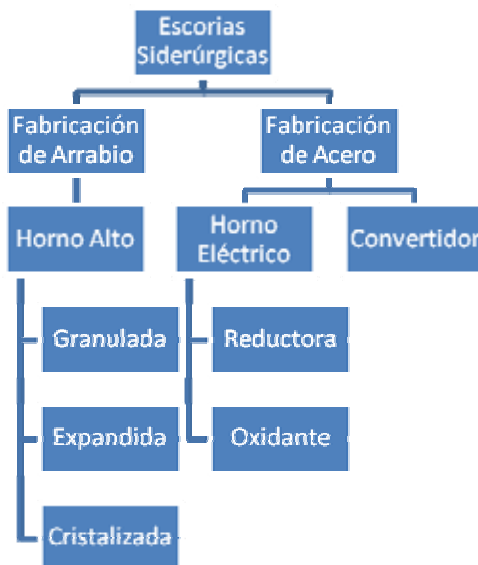
Figura 3. Clasificación de las escorias siderúrgicas según su origen (Amaral, 1999)
