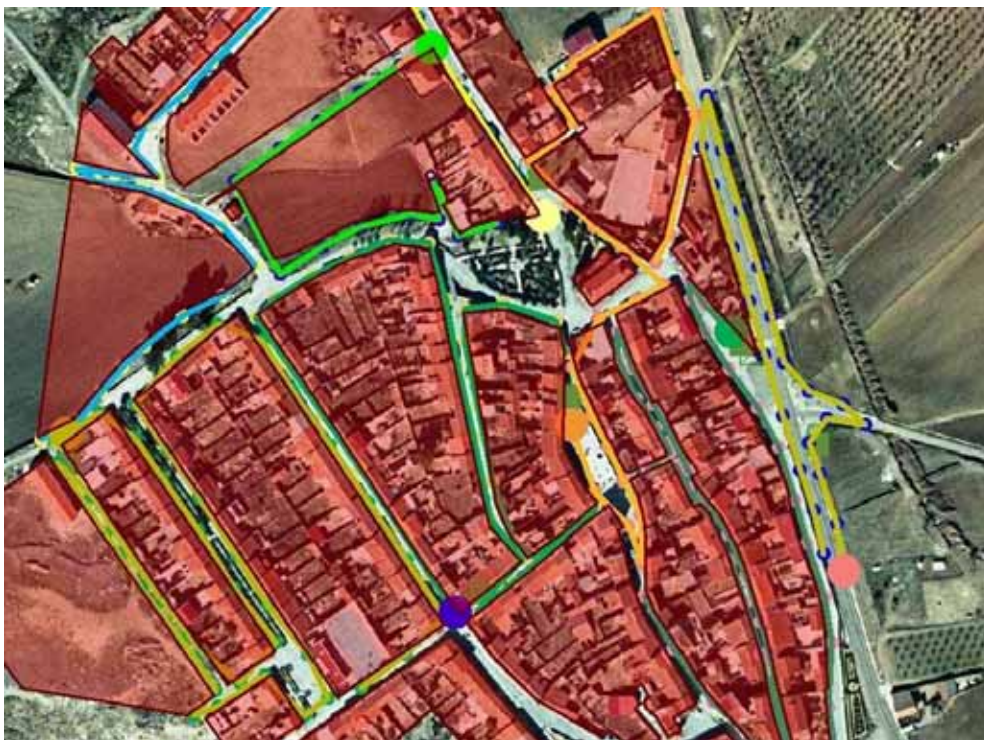
Figura 2.3. Vista caracterización instalación alumbrado público (módulo medida, centro de mando, circuitos y puntos de luz)
