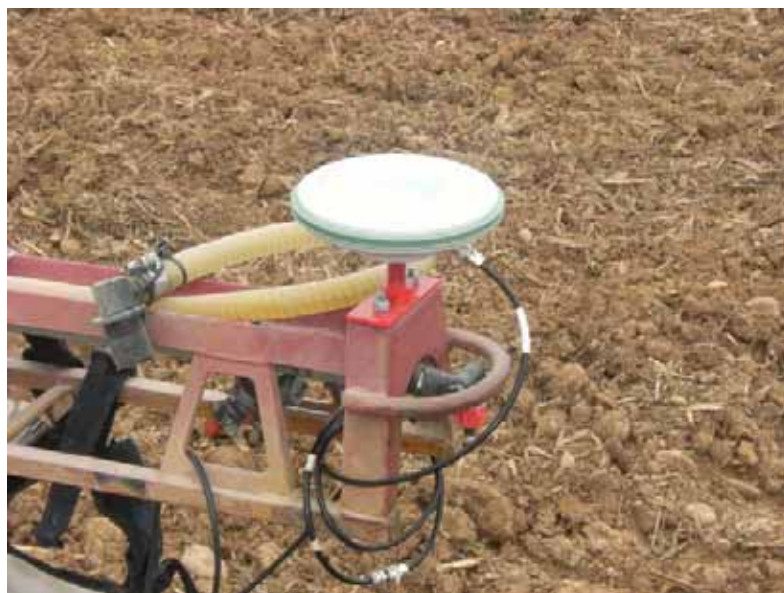
Foto 4. GPS con corrección RTK ubicado en el extremo de la barra pulverizadora.
