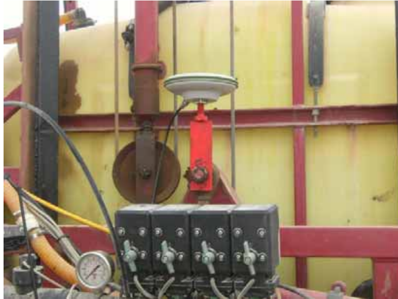
Foto 3. GPS con corrección RTK ubicado en el centro de la barra pulverizadora.
