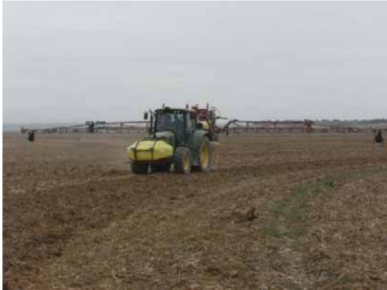
Foto 1. Vista frontal del equipo pulverizador suspendido trabajando en trayectoria circular.
