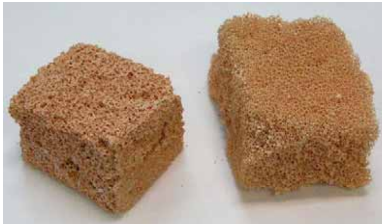
Figura 5. Soportes catalizador de poro grueso sin y con recubrimiento exterior, obtenidos en laboratorio
