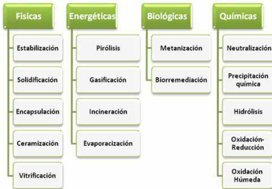
Figura 1: Técnicas de inertización de residuos
