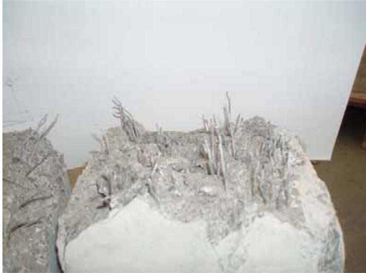
Se han realizado diversos estudios (tomografía axial computarizada, estudio de inducción electromagnética, inspección visual, etc) sobre las piezas cortadas del muro a fin de corroborar, y así ha ocurrido, las hipótesis iniciales sobre la orientación preferencial de las fibras en dirección longitudinal del muro.
