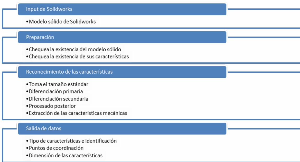
Figura 3: Procedimiento de reconocimiento de las partes de Solidworks
