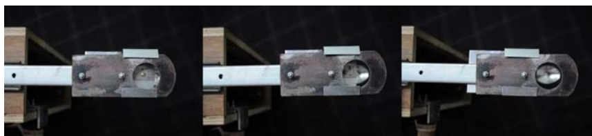
Figura 8: Secuencia de apertura del orificio para recarga de la cuchara
